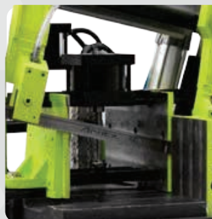
Morsa fija y morsa móvil de doble efecto. Opcional: Morsa superior.
