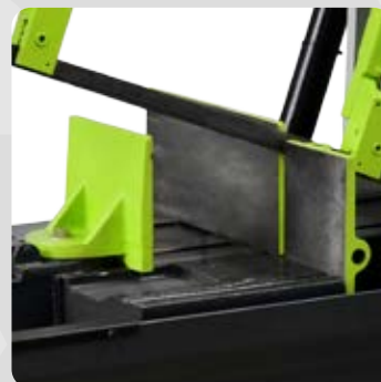
Morsa fija y morsa móvil para el apriete del material y posterior corte.
