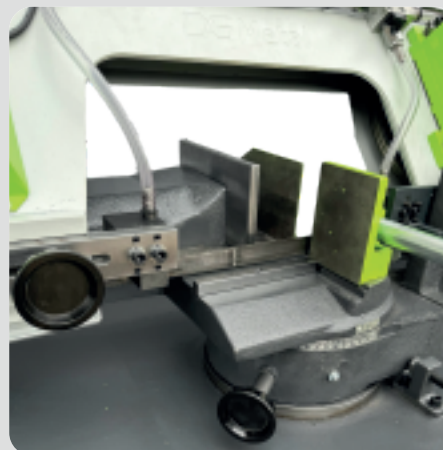
Morsa fija y morsa móvil para el apriete del material.
